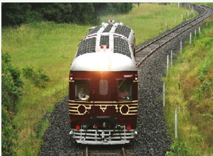
**Trem movido a energia elétrica gerada por painéis solares instalados no teto**
